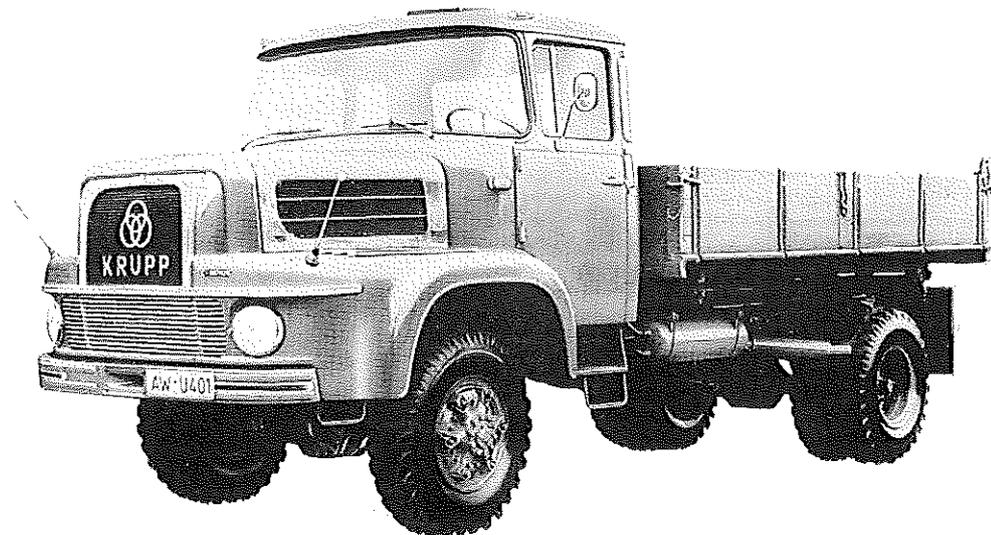
**Diesel-Motor · 6 Zylinder · 4-Takt · 186 PS bei 2600 U/min**
